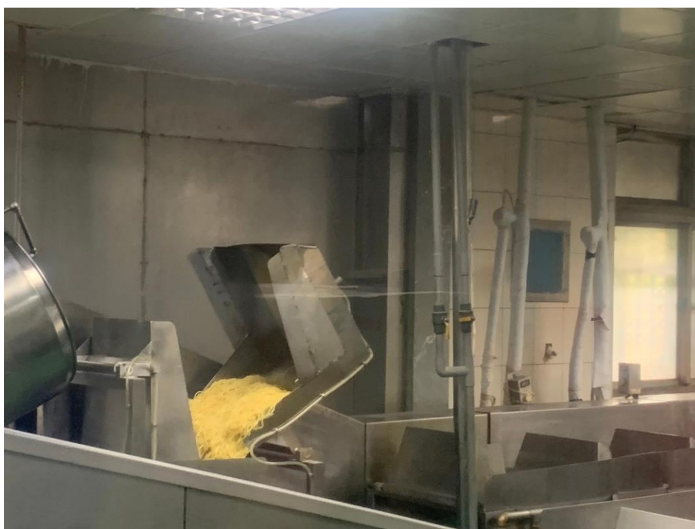
自動煮麵槽(3 熱-3 冷)-平台瀝乾-拌油-包裝
